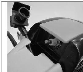
Снимите со свечи наконечник высоковольтного провода.
