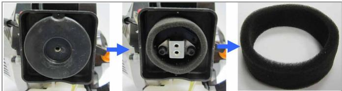
Снимите дефлектор воздушного фильтра и извлеките из корпуса воздушного фильтра фильтрующий элемент (поролоновую губку).
