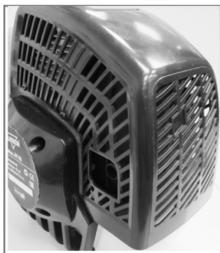
Вентиляционные отверстия на корпусе двигателя, а также ребра охлаждения цилиндра во время работы могут забиваться сухой травой. Это может привести к перегреву двигателя. Поэтому периодически прочищайте вентиляционные отверстия и ребра охлаждения цилиндра кисточкой или сжатым воздухом.
