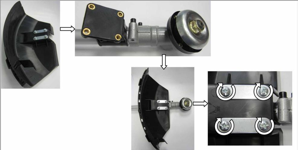
Установите защитный кожух на кронштейн. Совместите винты кожуха с отверстиями на кронштейне. Закрутите винты отверткой по часовой стрелке
