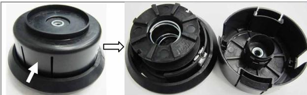
Нажмите на две защелки корпуса катушки. Снимите крышку катушки.
