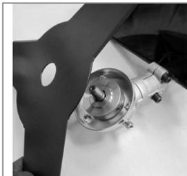
Установите на защитный фланец режущий нож.
