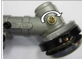
Отверткой закрутите винт редуктора.
