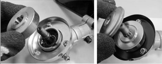
Установите защитный фланец на триммерную головку.
