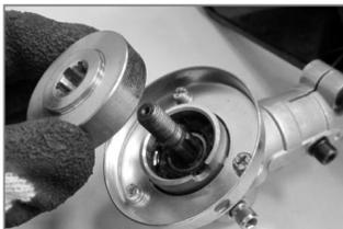
Установите защитный фланец на триммерную головку.
