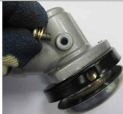
Проверьте через отверстие наличие смазки в редукторе. Если необходимо добавьте с помощью шприца смазку в редуктор.
