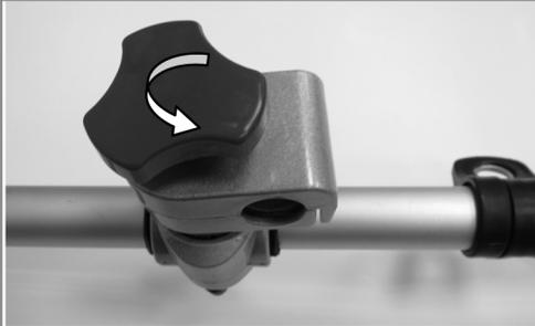
Открутите ручку фиксации рукоятки управления против часовой стрелки.
