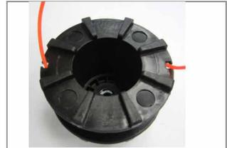
Зафиксируйте концы лески длиной 10-15 сантиметров в пазы на корпусе шпули.
