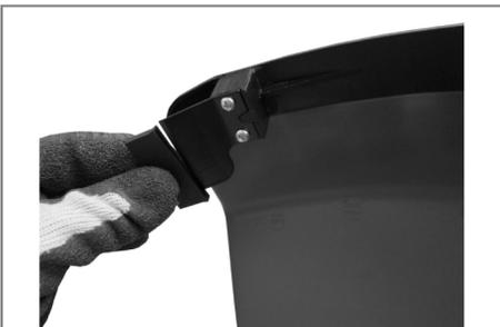
Снимите с ножа защитного кожуха чехол. Данный нож обрезает излишек лески при ее полуавтоматической подаче.
