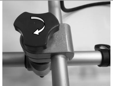
Установите крышку фиксирующего зажима и закрутите по часовой стрелки ручку фиксации рукоятки управления.
