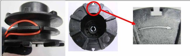
Возьмите отрезок лески длиной примерно 5м, сложите его пополам. Вставьте петлю лески в паз посередине шпули. Намотайте леску на шпулю в два ручья. Направление намотки лески указано стрелкой на корпусе шпули.
