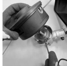
Совместите отверстия на защитном кожухе и защитном фланце триммерной головки. Вставьте шестигранный ключ в отверстие кожуха, заблокировав вал и накрутите катушку на вал триммерной головки.
