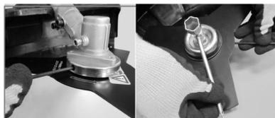
Совместите отверстия на защитном кожухе и защитном фланце триммерной головки. Вставьте шестигранный ключ или отвертку в отверстие кожуха, заблокировав вал. Затяните гайку комбинированным ключом.
