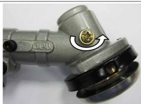
Отверткой открутите против часовой стрелки винт редуктора.
