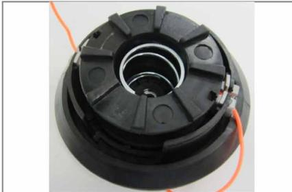
Установите шпулю в корпус катушки, предварительно заправив концы лески в выходные отверстия на корпусе катушки.
