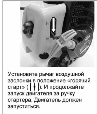
После запуска двигателя дайте ему поработать одну минуту, чтобы он прогрелся. Затем выжмите до конца курок газа и приступайте к работе.
