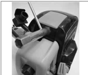
Комбинированным ключом открутите свечу зажигания против часовой стрелки.
